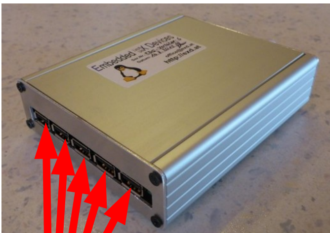
Abbildung 15: EBG Verteiler mit 5 USB-A Ausgängen
